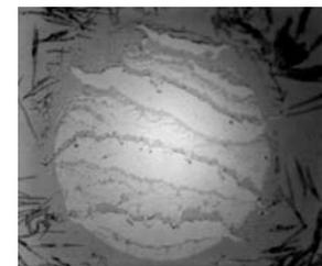
Observation in situ d'un contact entre un substrat polyamide et une lentille de saphir en situation d'usure.
