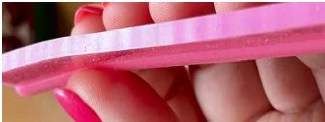
Motif sinusoïdal sur la surface découpée flexible
