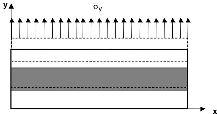
*Schéma simplifié d'une traction transversale*
