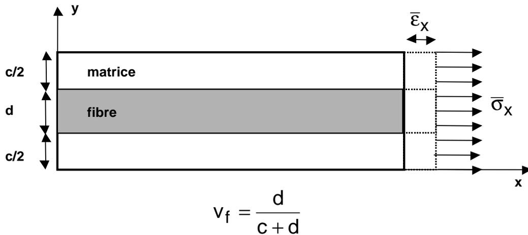
*Schéma simplifié d'une traction longitudinale*
